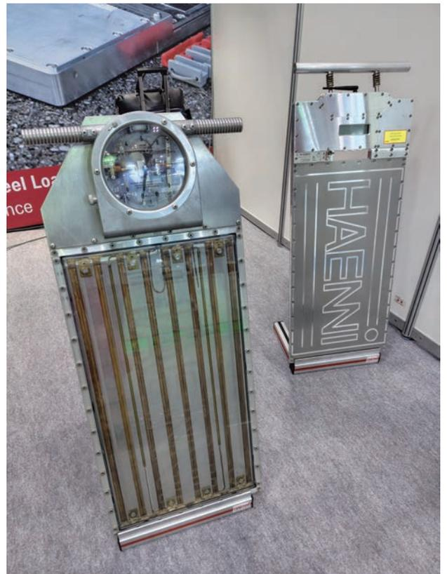
Wheel Load Scale WL 101（写真左）、108（写真右）
